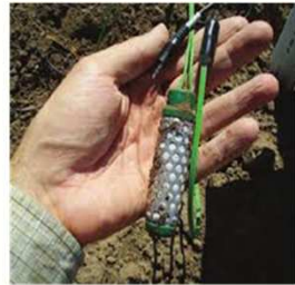
Bloques de yeso (sensores matriz granular)
