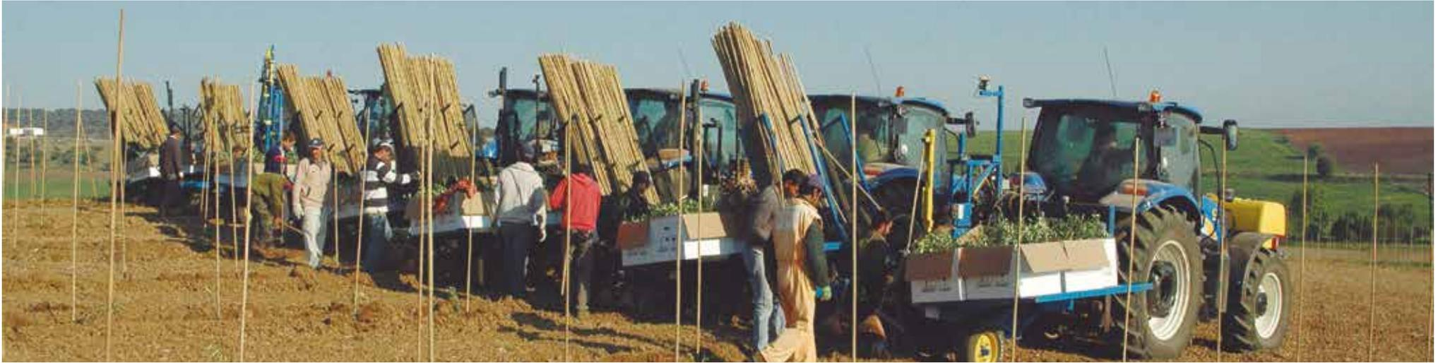
**Sistema de alineación GPS · Colocación simultánea de planta y tutor**
